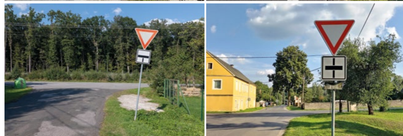
Zbytečné dodatkové tabulky vyznačující standardní tvar křižovatky
