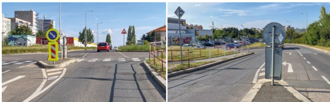
Nadbytečné a zvýrazněné značení zakrývá dospělého chodce, z ostrůvku pak zakryje i autobus
