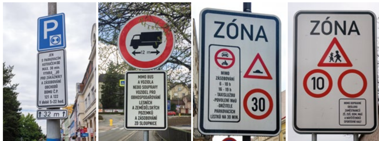
Dodatkové tabulky vyžadující zastavení vozidla, aby bylo možné je přečíst a vyhodnotit
