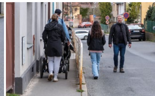
Zábradlím zúžený úzký chodník může vést k neprůchodnosti a nutnosti míjení za použití vozovky
