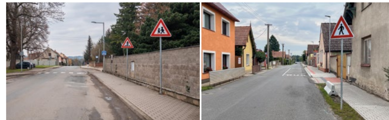
Zbytečné umístění SDZ A 11 Přechod pro chodce na přehledném a přímém úseku
