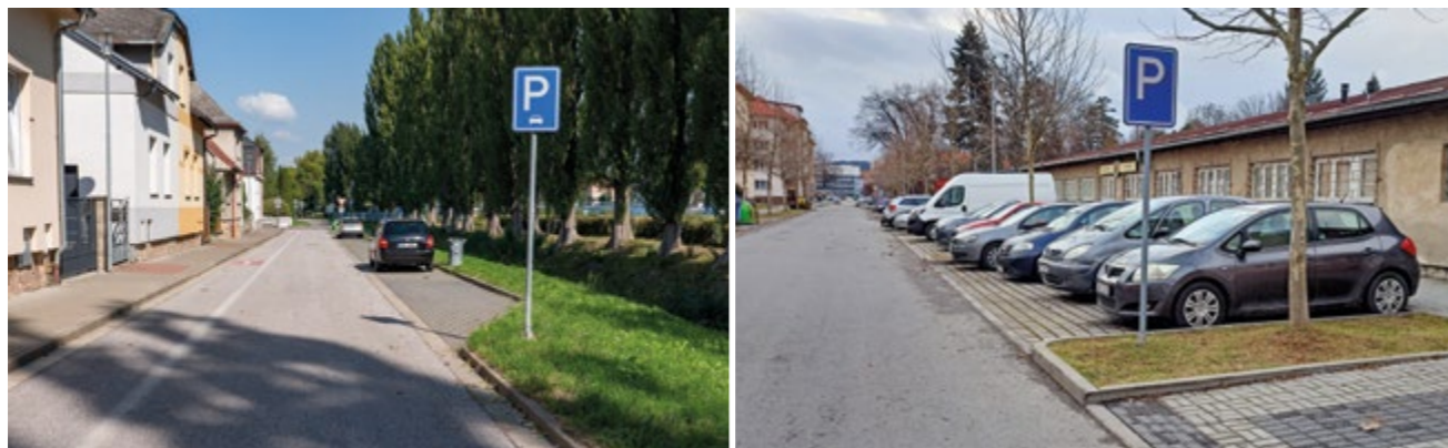
Zbytečně osazená značka vyznačuje zřejmé plochy parkování
